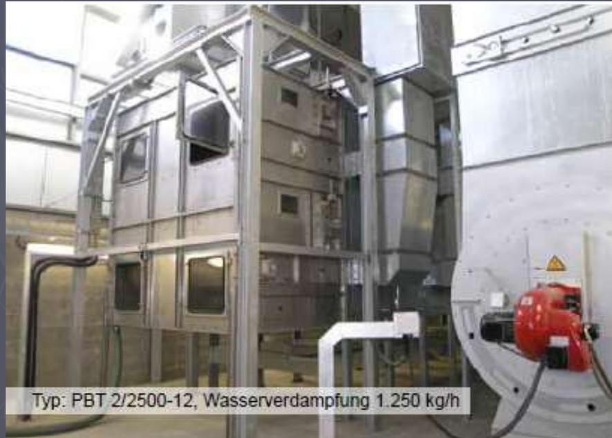
Typ: PBT 2/2500-12, Wasserverdampfung 1.250 kg/h
